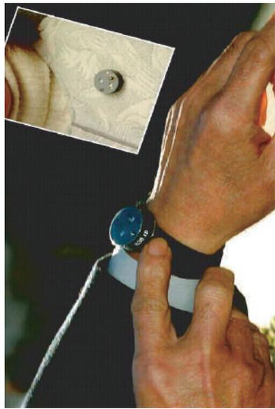
腕時計型の測定器(数十グラム)を主として非利き腕手首に装着し、サンプリングタイム10msec、加速度分解能0.01Gで加速度を継続的に測定。
