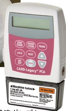
注入器（携帯型精密輸液ポンプ）
