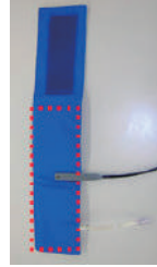
【注意】 レーザセンサー先端部がブラダマー(袋)の中央になるように配置して下さい。
